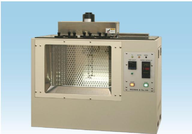
本装置は、JIS K2283、ASTM D445、ISO 3104 の規格に基づき設計・製作された高温用の動粘度測定用精密恒温槽です。毛細管粘度計を 7 本掛けられます。ステンレス製の角型恒温槽で耐久性に優れ、観察窓は動粘度測定に最適な板ガラス二重構造になっていますので、安全性は勿論、内部観察が容易な設計になっています。恒温槽の温度制御方式は P. I. D. 制御を採用していますので設定温度に対して  $\pm 0.03^{\circ}\text{C}$  以内の精度で常に安定した温度が得られます。
