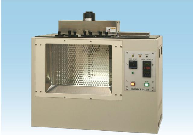
本装置は、JIS K2283、ASTM D445、ISO 3104 の規格に基づき設計・製作された動粘度測定用精密恒温槽です。毛細管粘度計を 7 本掛けられます。ステンレス製の角型恒温槽で耐久性に優れ、観察窓は動粘度測定に最適な板ガラス二重構造になっていますので、安全性は勿論、内部観察が容易な設計になっています。恒温槽の温度制御方式は P. I. D. 制御を採用していますので設定温度に対して  $\pm 0.01^{\circ}\text{C}$  以内の精度で常に安定した温度が得られます。
